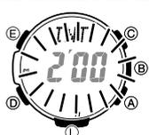
1. No modo do altímetro, pressione (E) durante pelo menos dois segundos. **SET Hold** piscará no mostrador e **ALTI** aparecerá no mostrador superior. Pressione (E) até que **ALTI** apareça.
