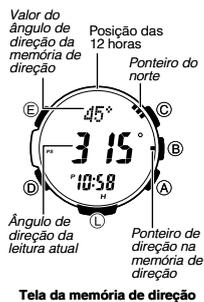
A memória de direção lhe permite armazenar temporariamente e exibir uma leitura de direção, de forma que possa usá-la como uma referência ao tomar leituras subsequentes com a bússola digital. A tela da memória de direção exibe o ângulo de direção para a direção armazenada, junto com um ponteiro que indica a direção armazenada.
