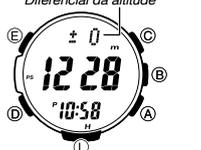
1. No modo do altímetro, selecione a Tela 2 como a exibição para o modo do altímetro (página P-53).
