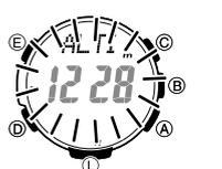
1. No modo do altímetro, pressione (E) durante pelo menos dois segundos. SET Hold piscará no mostrador e ALTI aparecerá no mostrador superior. Pressione (E) até que ALTI apareça.
