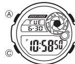
Le rétroéclairage emploie une DEL (diode électroluminescente) et un panneau guide lumineux qui éclairent tout l'afficheur pour le rendre mieux visible dans l'obscurité.
