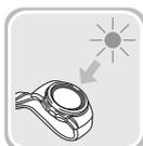
Cuando lleve puesto el reloj, asegúrese de que la manga no bloquee la pantalla LCD (panel solar). La eficiencia en la generación de energía se reduce incluso cuando la pantalla LCD está bloqueada parcialmente.
