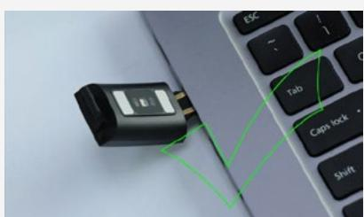
\*Important : sur les deux extrémités du boîtier de la montre, seule une fait office de câble USB. Ne branchez pas la mauvaise extrémité, cela risquerait de provoquer un court-circuit.
